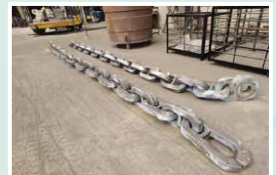
采用精壳特种工艺研发制造的矿山拉铲链条
